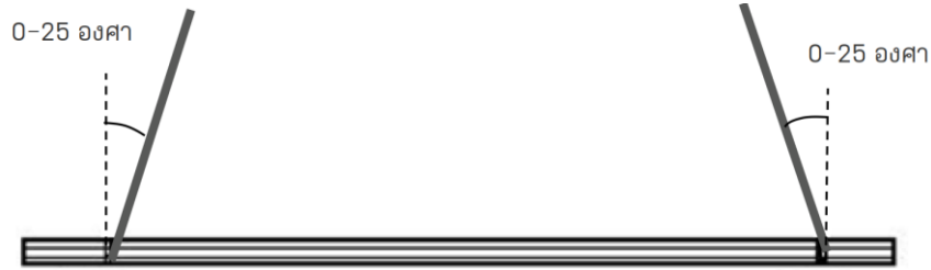
รูปที่ 26 แสดงการยกแผ่นพื้นคอนกรีตฯที่ถูกต้อง
