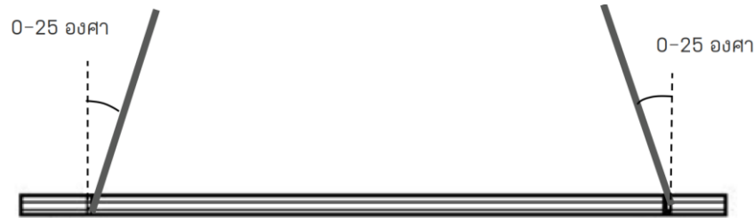
รูปที่ 26 แสดงการยกแผ่นพื้นคอนกรีตที่ถูกต้อง
